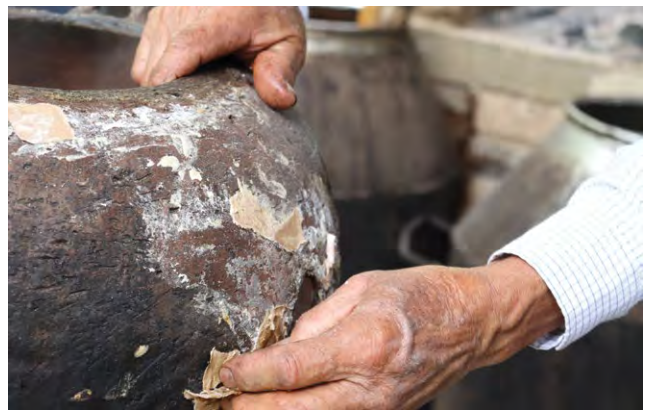
Gregorio desmonta las juntas de papel y engrudo que unen las partes del alambique.
