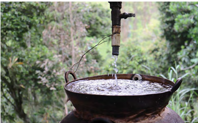
El sistema de refrigeración mete agua a la olla de cobre con una manguera y la saca por uno de los costados.
